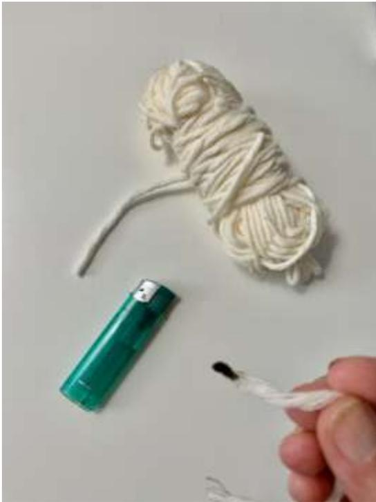
BILD 7: Aus welchem Rohstoff besteht dieses Garn? Fasererkennung durch Brennproben
